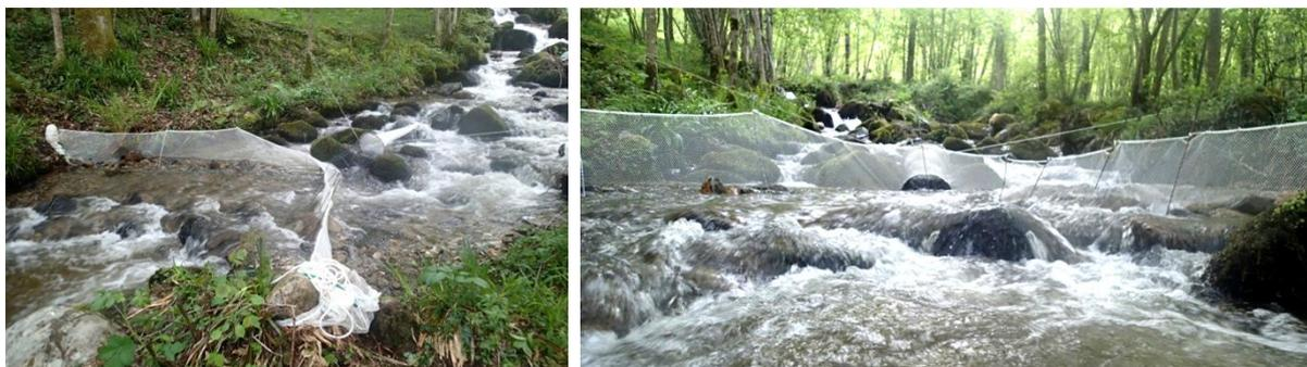
**Figure 9 : Pièges à ailettes**
