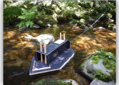
*Radeau positionné sur le site de l'Aston (09) et plaque d'argile fréquentée lors d'un relevé © ANA*
