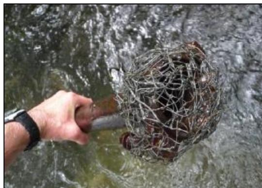
**Photo 2 : Tuyau équipé d'un dispositif de protection artisanal et vulnérant © F. Blanc**
