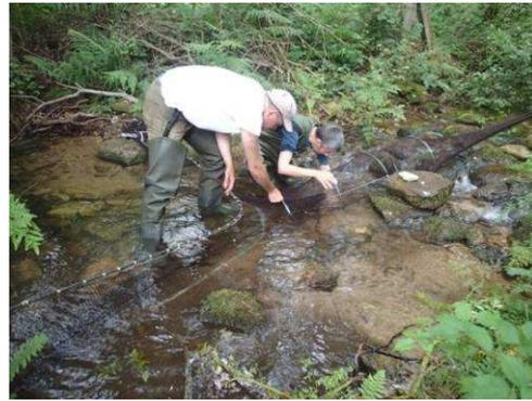
**Illustration 107 : Visite de terrain en Galice avec l'équipe ARCEA en juin 2014 : mise en place d'un lecteur automatique de transpondeur avec barrière filet associée, barrant toute la largeur du cours d'eau et canalisant les animaux vers le lecteur et mise en place d'une nasse à Desman avec barrière filet associée (© GREGE)**
