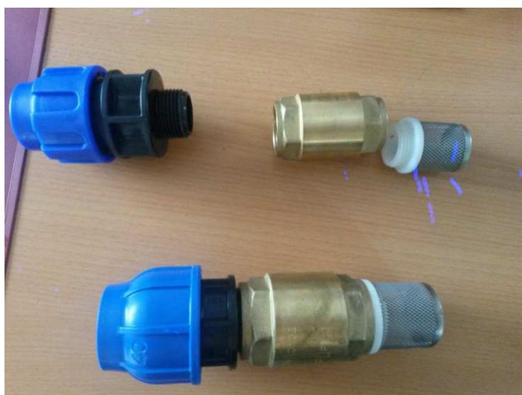
*Illustration 48 : Crépine pour tuyau de 32 mm installée dans les Pyrénées-Orientales (©FRNC)*
