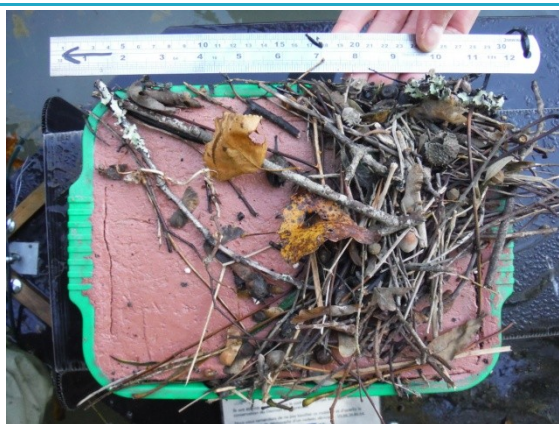
Site FR7200790 – Radeau 264 – 23/10/14. De nombreux branchages ont recouvert le capteur qui n'est plus que partiellement opérationnel.
