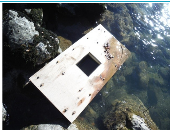
Site FR7200790 – Radeau 269 -23/10/14. Radeau emporté par les crues et retourné. Perte du capteur et du tunnel.
