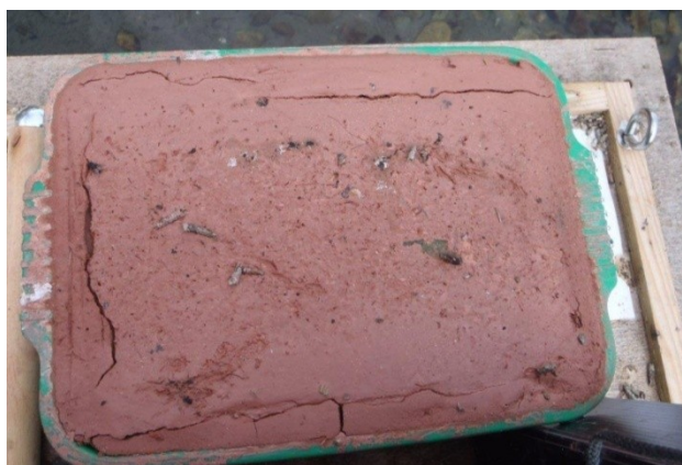
Site FR7200793 – Radeau 272 – 18/08/2014. Radeau fortement fréquenté par les cincles qui souillent et détériorent le capteur.
